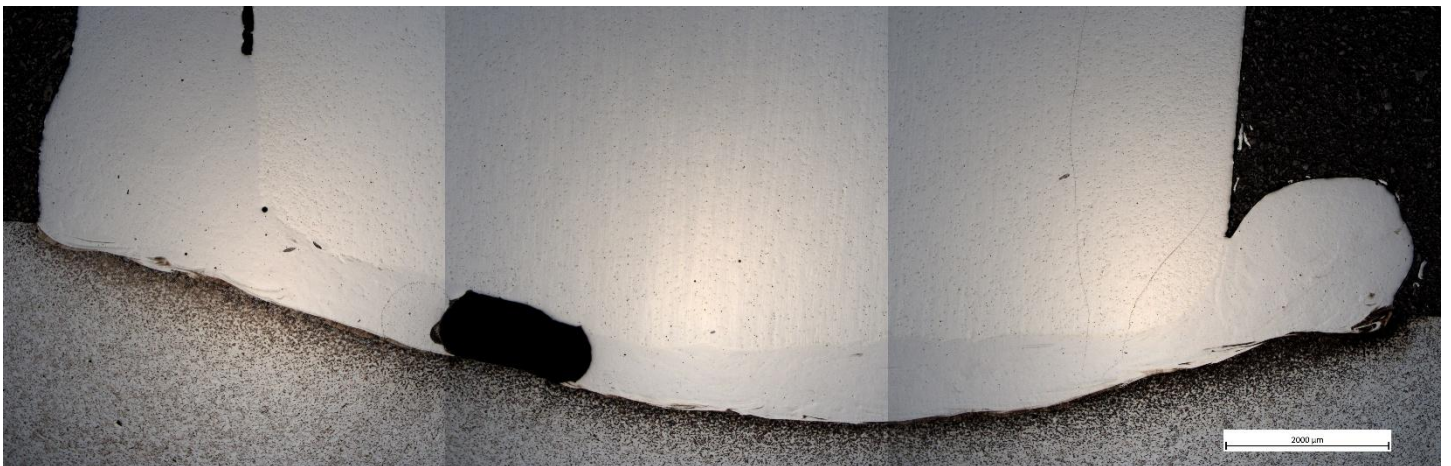
Obr. 14 – Mikrostruktura celého svarového spoje č. 4 – zvětšení 25x
