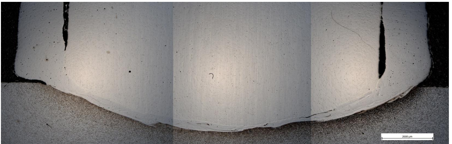
Obr. 8 – Mikrostruktura celého svarového spoje č. 1 – zvětšení 25x
