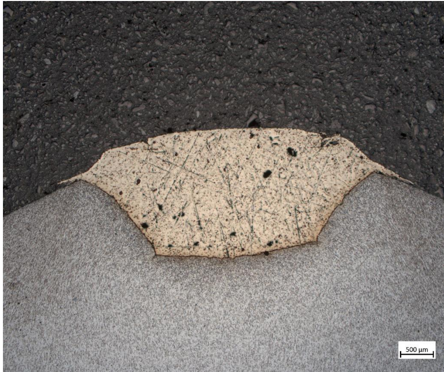
Obr. 17 – Mikrostruktura koncové části svorníku (před navařením) – zvětšení 25x
