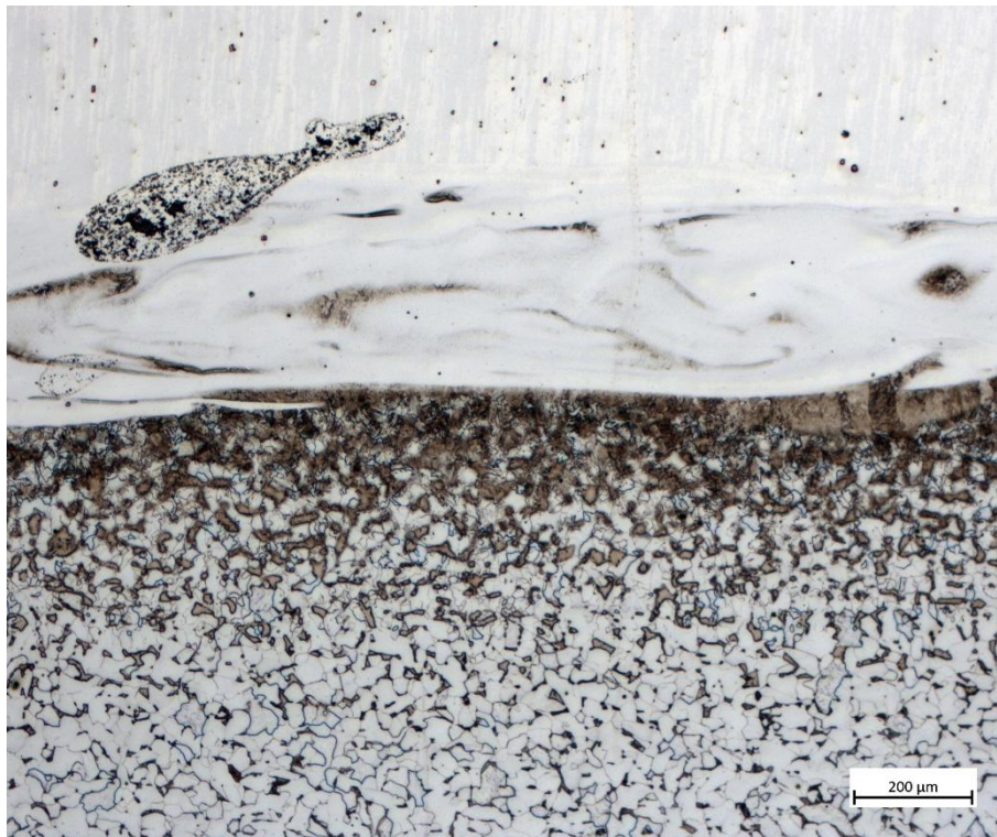
Obr. 15 – Detail mikrostruktury svarového spoje č. 5 – zvětšení 50x (přechod mezi svorníkem – horní část obrázku a podkladovým plechem – spodní část obrázku)
