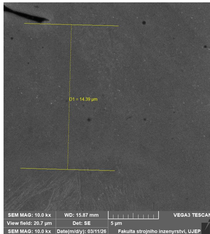
Obr. č. 41 – Defekt není přesně na rozhraní, ale je cca 14 µm od rozhraní.
