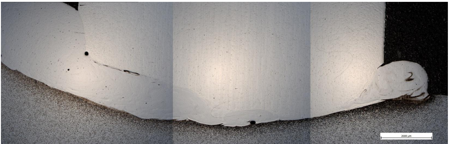
Obr. 12 – Mikrostruktura celého svarového spoje č. 3 – zvětšení 25x
