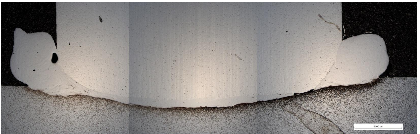
Obr. 10 – Mikrostruktura celého svarového spoje č. 2 – zvětšení 25x
