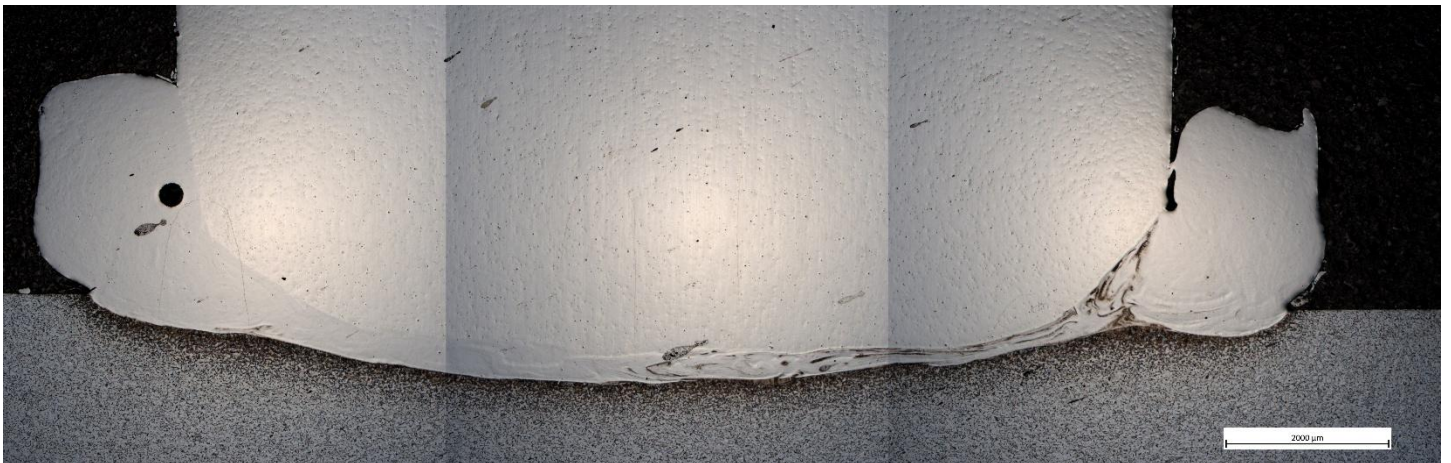
Obr. 16 – Mikrostruktura celého svarového spoje č. 5 – zvětšení 25x
